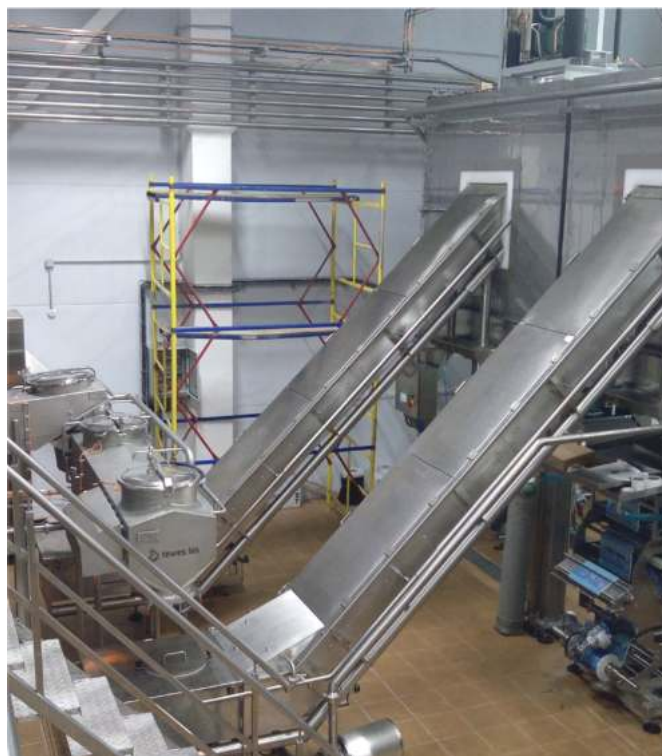
Защищенный тракт подачи продукта с закрытой зоной дозирования продукта
